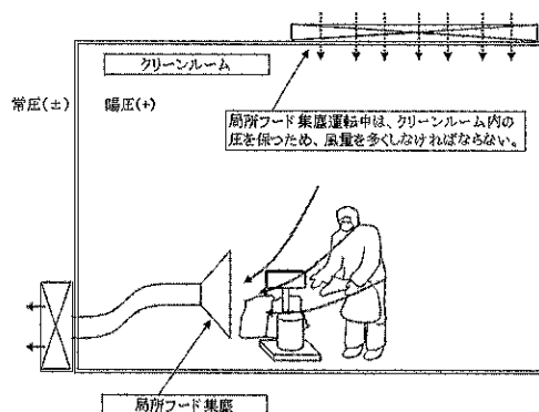
Fig.2 従来のフードを使用した局所集塵の場合
