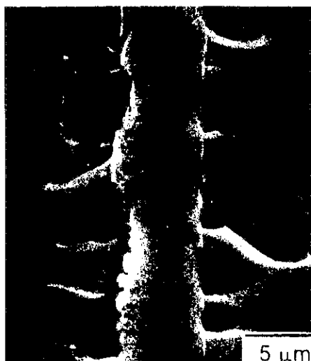
Fig.2 固体反応のトポケミストリー(9). Si(111) 表面に縦方向に加えられた引っかかり傷(スクラッチ)の側方には、多数のクラックが発生する。その後、KOH溶液で腐食させると、クラック先端部分から優先的に溶解が起こる。この部分に歪みが集中してマイクロ塑性変形や部分的非晶質化が起こるためである。
