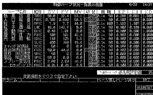
Photo. 4 制御ループ状況一覧表示画面
