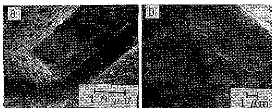
Fig. 15(b) この方法で室温の基板上に作製された超電導体の厚膜(a)とその断面(b)
