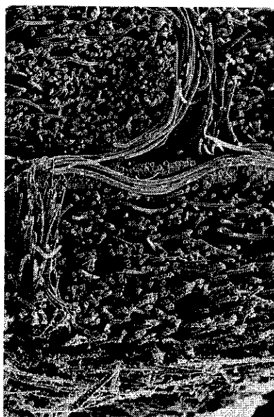
Fig. 17 33 \text{ g/m}^2 の粉塵が堆積したポリエステルニードルフェルトの断面写真 (SEM), \Delta P = 110 \text{ Pa}
