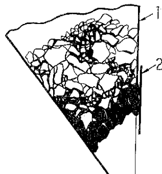
Fig. 1 摩擦による塊状物の架橋の形状
