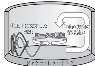
図12 ノビルタベルコム内の粉体材料の流動状態
