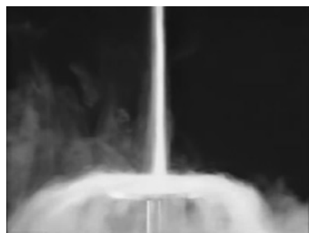
図-11 複合粒子の安息角測定テスト
