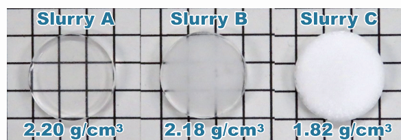
図1 異なる原料混合操作で調製したスラリーから得た成形体（A：遊星混合とボールミル、B：遊星混合、C：意図的な凝集体生成操作、スラリーの配合組成や成形プロセスは同一）を焼成した様子。
