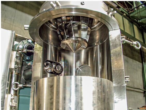
図1 DMR 機内分級部 Fig. 1 DMR in-machine classifier.
