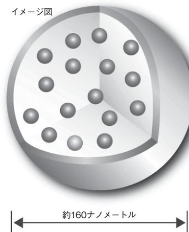
図2 PLGAナノカプセルの構造
