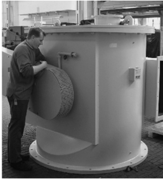
写真-2 ツインターボプレックス500TTCの外観 (分級点: x_{97} = 2\mu\text{m} )
