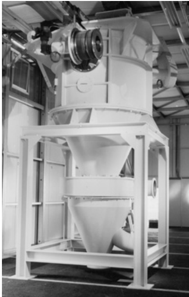
写真-1 ターボプレックス500/3ATP-NG (分級点 x_{97} = 3\mu\text{m} )
