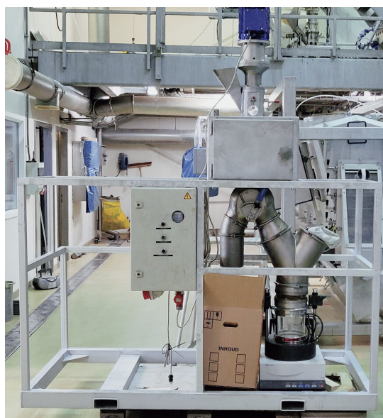
図3 FX-100 造粒システムの実験装置（供給機は写っていない）
