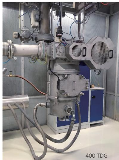
図2 HOSOKAWA ALPINE AG のテストセンターに配置された 400 TTD の装置外観とタルク試験での原料および製品の粒子径分布<sup>[6]</sup>
