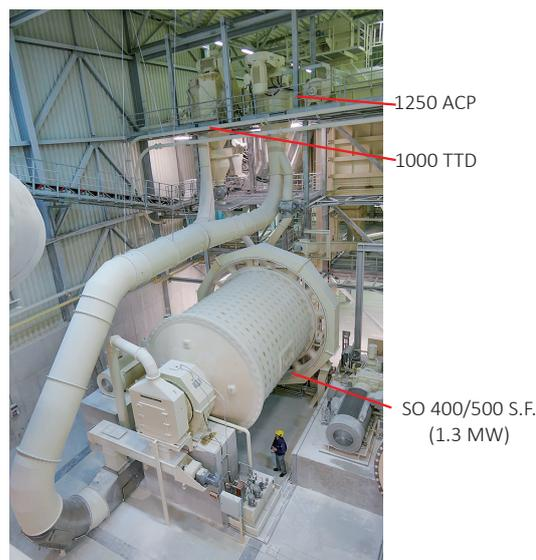
図6 GCC合成用のプロセスプラント (ボールミルと分級機の連結型)<sup>[6]</sup>
