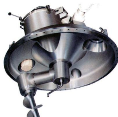
図9 ドームカバー (ナウタミキサ<sup>®</sup> 用) の外観<sup>[3]</sup>
