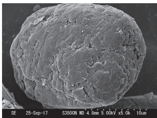
図5 球形化処理後の粒子のSEM写真 Fig. 5 SEM photographs of spherized particles.
