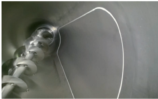
図7 機内から見たビッグドア部 Fig. 7 Big Door part seen from the inner vessel.
