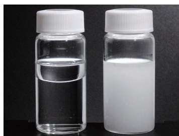
図4 TOCNF によるヘキサデカン乳化物の安定化 (左: ブランク, 右: 0.2 wt% TOCNF 含有)
