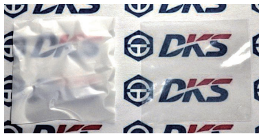
図7 ナノジルコニア複合皮膜 (左: CMC / ナノジルコニア, 右: TOCNF / ナノジルコニア, 重量比: 50/50) Fig. 7 Nano zirconia composite film (left: CMC/nano zirconia, right: TOCNF/nano zirconia, ratio by weight=50/50).
