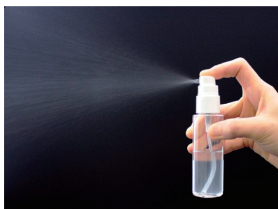
図3 0.5 wt% TOCNF 水分散液によるスプレー可能なゲル
