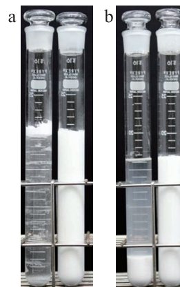
図5 TOCNF による沈降抑制効果。(a) 10 wt% 酸化チタン懸濁液, (b) 10 wt% 炭酸カルシウム懸濁液, (左: ブランク, 右: 0.2 wt% TOCNF 含有)
