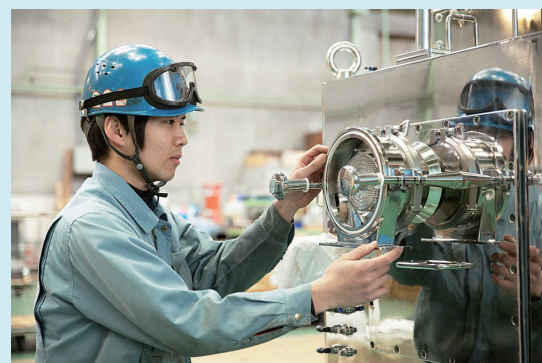
粉砕機の組立作業
