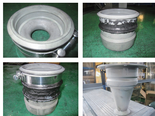
図5 試作ベンチュリ例 Fig. 5 The prototype venturi.
