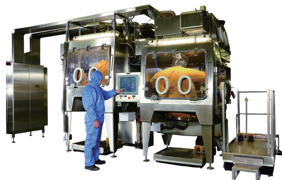
図5 特殊型アイソレータ Fig. 5 Specialized isolator
