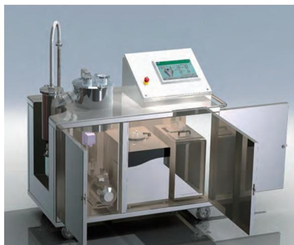
図7 実験室用AFDユニット (操作盤, 真空システム, 凍結コンデンサ, 加熱・冷却装置を含む)
