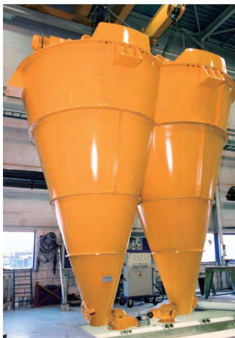
図3 ナウタミキサのダブルコーン型、高さを上げないためにダブル型にした
