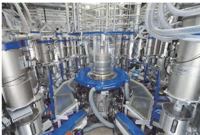
図 18 運転中の 11 層インフレーションフィルム製造ライン (テストセンターにて) Fig. 18 The 11 layer blown film co-extrusion line in operation in our test center
