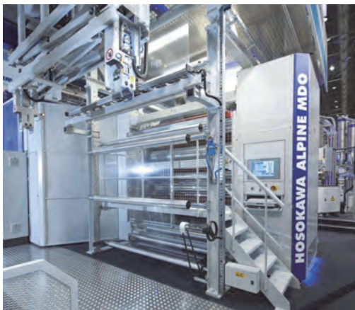
図 20 1 軸延伸フィルム製造システム MDO Fig. 20 Mono-axial film orientation line MDO
