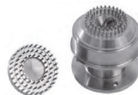
図 15 ピコプレックスのモジュール部材の粉碎部
