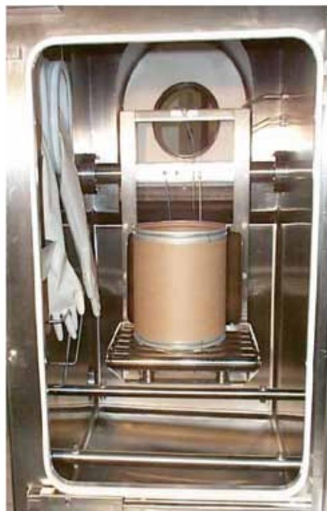
図4 チッピングアイソレータ内部
