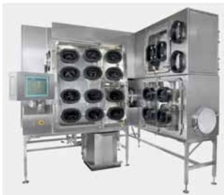
図5 粉碎アイソレータと秤量アイソレータ
