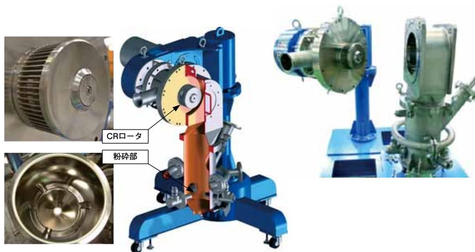
図4 テスト機200AFG-CRの構造
