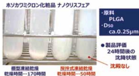
図18 AFD 乾燥品の製品評価
