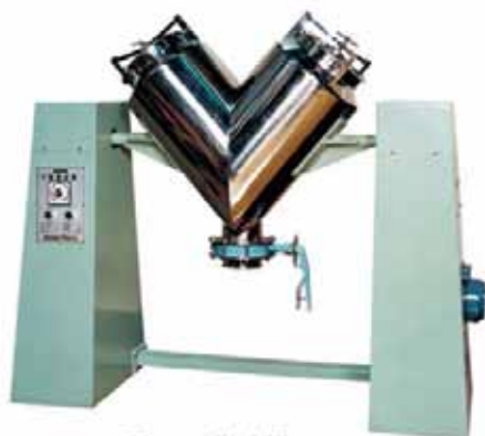
図3 V型混合機
