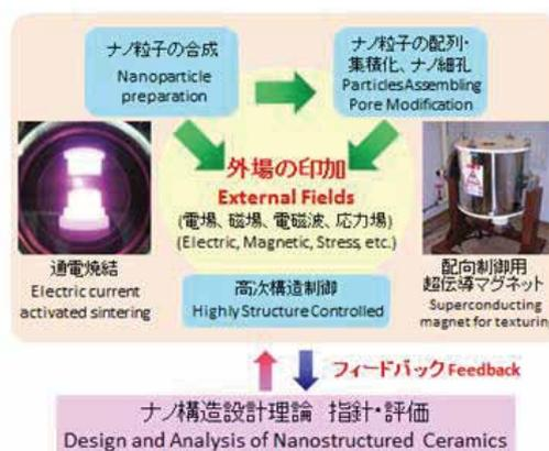
図1 先端セラミックス創製の要素技術。外場としてパルス通電焼結（左図）と超伝導マグネット（右図）を示す
