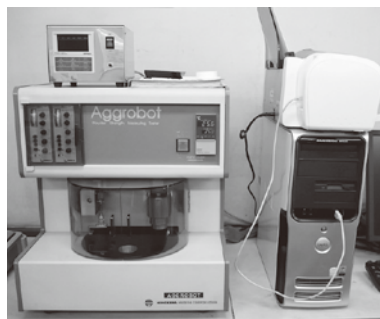
付着性・凝集性の評価装置 (アグロボット)
