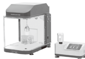
濡れ性の評価装置 (ペネトアナライザ)
