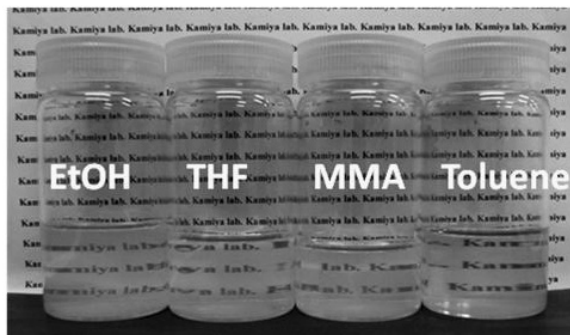
図6 表面修飾したチタニアナノ粒子の異なる有機溶媒中での分散特性
