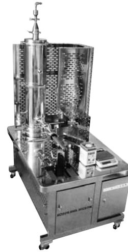
写真28 各種複合ナノ粒子の少量サンプル作製可能なFCM-MINI
