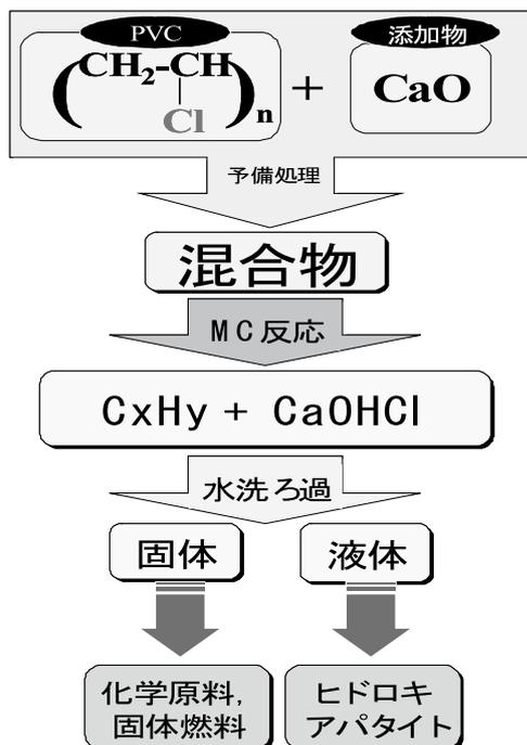
図12 MC処理と水洗処理によるPVCの脱塩素と処理産物の利用例
