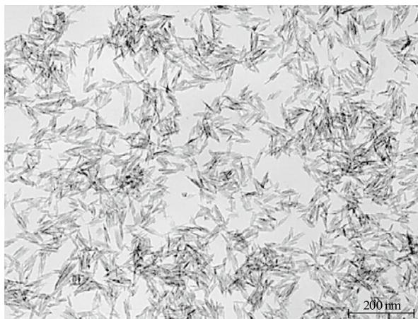
図6 水和アルミナ処理済黄色透明酸化鉄粒子
