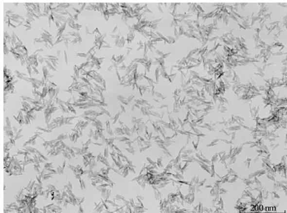
図5 シリコン処理済赤色透明酸化鉄粒子
