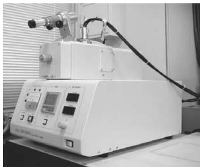
試料断面加工装置
