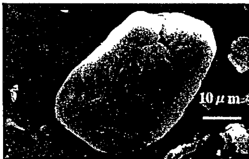
図7 リチウムイオン電池負極用炭素材料粒子の球形化例
