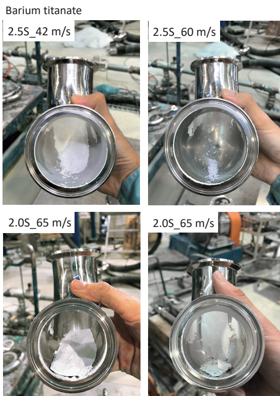
図6 エルボ部の配管径を変更した場合の付着の様子 Fig. 6 Adhesion when the pipe diameter of elbow was changed.
