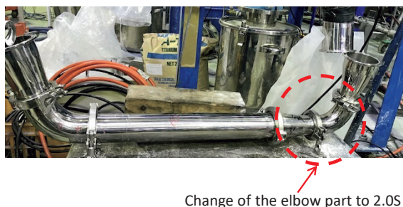
図5 実験2の実験風景 (2.0S エルボ使用) Fig. 5 Photo of Experiment 2.
