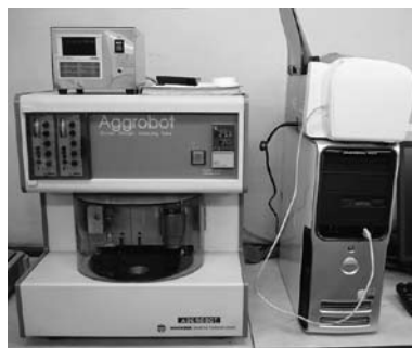
付着性・凝集性の評価装置 (アグロロボット)
