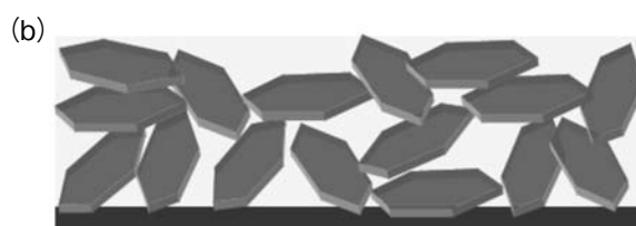
板状粒子を用いた電極
