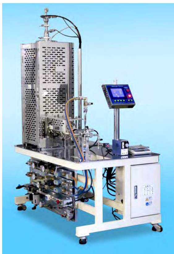
写真：30分のバッチ運転で10g程度を作製できる 実験室用多成分複合酸化物ナノ粒子合成装置 “ナノクリエイター FCM-MINI”
