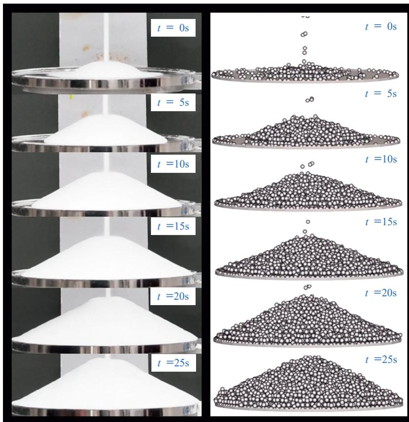
図5 パウダテスタ® とシミュレーションによる安息角形成の時系列変化
