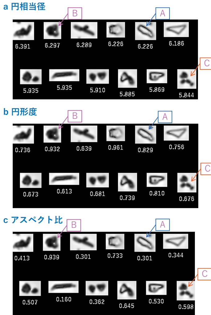
図3 アルミナの測定画像 (a: 円相当径, b: 円形度, c: アスペクト比) Fig. 3 Measured image of alumina. (a: circle equivalent diameter, b: circularity, c: aspect ratio)
