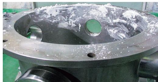
図9 プロトタイプの機内付着状況
