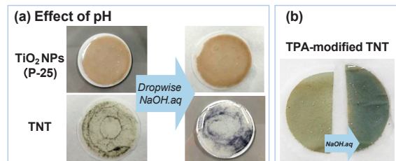
図5 酸化チタンナノ粒子 (P25) および TNT を用いて光照射法で作製した PANI 複合材料の pH 変化による色調変化 (a) およびリンカー修飾 TNT-PANI ナノハイブリッドの色調変化 (b)。
